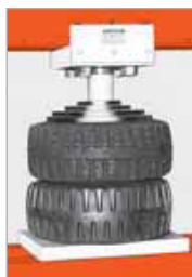
Introduction d'une jante dans un pneu neuf au moyen d'une presse Power Team.
