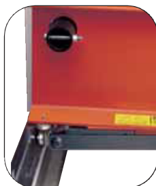
Les roulements permettent un déplacement de la table très aisé et sans chocs.
