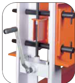
Une tige filetée et des goupilles de blocage permettent à un homme seul de lever ou d'abaisser la traverse supérieure.
