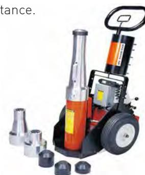
**Série modulaire (55, 100 ou 150 tonnes)**, permettant d'adapter rapidement des embases de différentes hauteurs, et des vérins de différents tonnages. Alimentation en 110V ou 6 bar.
